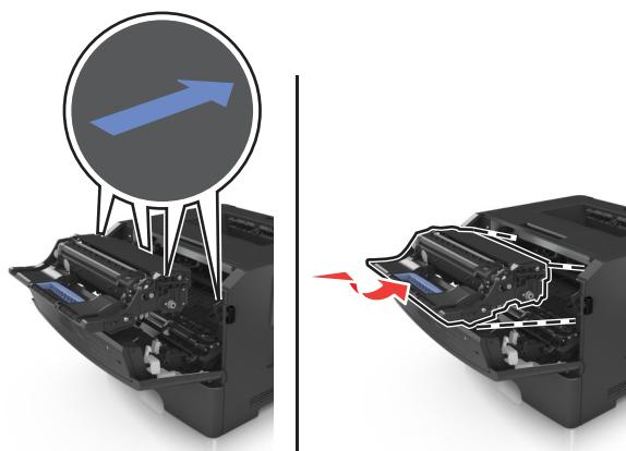
**8** 插入碳粉匣時，請先將碳粉匣邊欄上的箭頭對準印表機內側邊欄上的箭頭，再將碳粉匣插入印表機。
