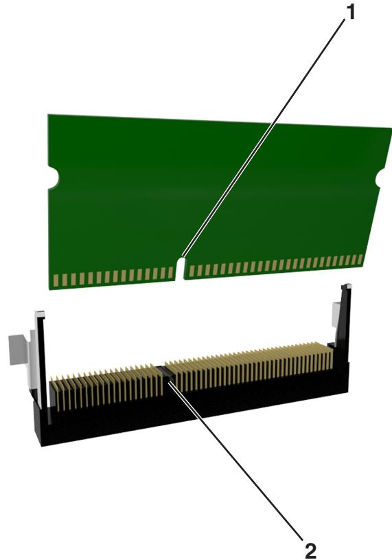
4 將記憶卡垂直推入連接器中，然後將插卡推向控制板內壁，直到它發出喀嚓一聲， 卡入定位。
