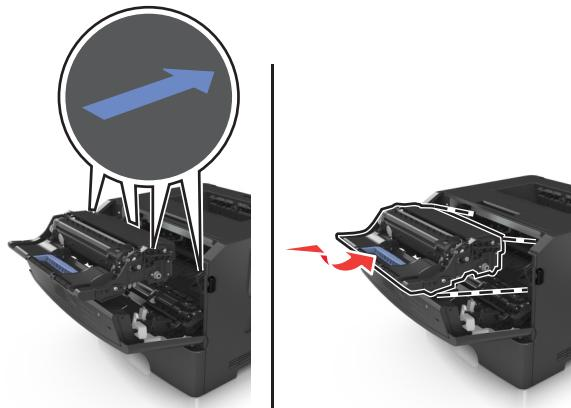
7 將碳粉匣插入印表機，插入時，請將碳粉匣邊欄上的箭頭對準印表機內側邊欄上的箭頭。
